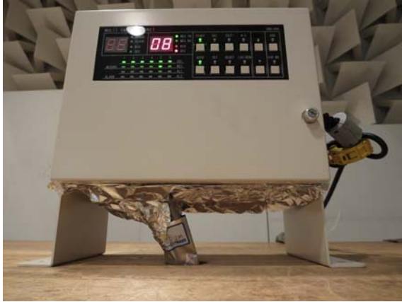
写真6 3.4の状態でコネクタ部アルミ箔シールド
